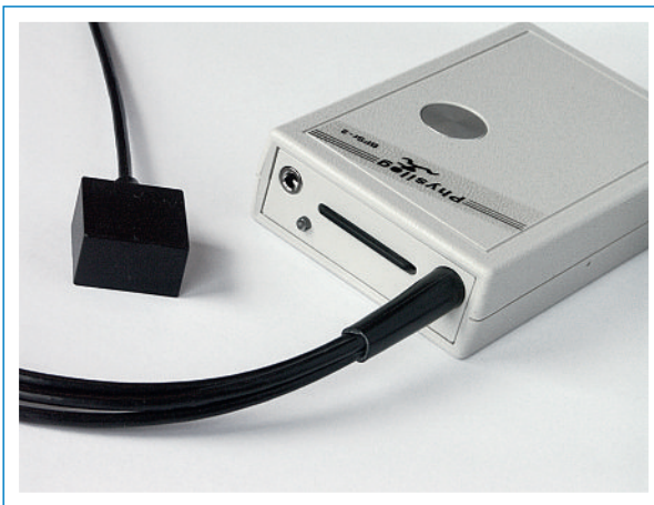
Figure 2 Le boîtier Physilog enregistrant les données et un capteur comprenant un accéléromètre 3D et un gyroscope 3D.
